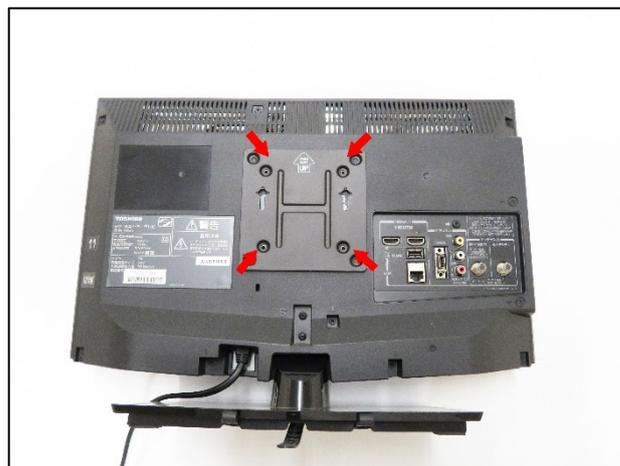
1. 付属品のブラケットを取り出し、ディスプレイの背面に取付けます。 2. 上の4つのネジ穴に位置を合わせます。
