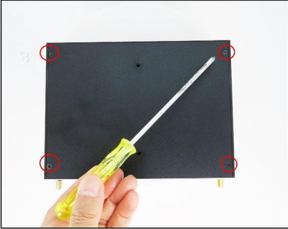
1. プラスドライバーでパソコン背面のネジ(4箇所)を取り外します。
