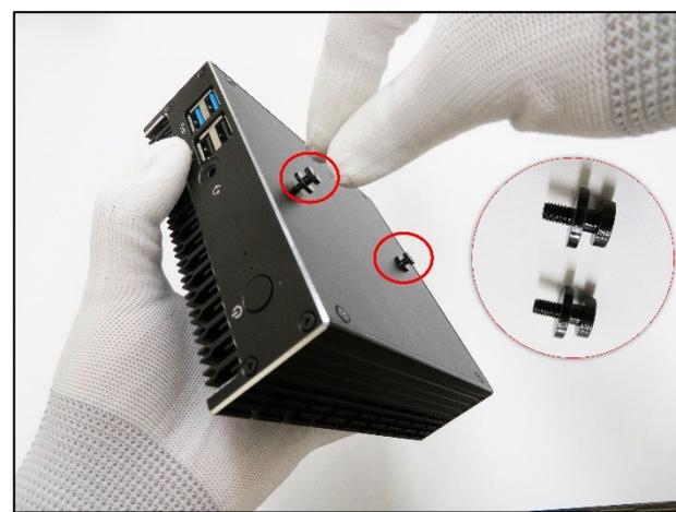
3. 付属品のブラケット固定用ネジ(4個)を取り出し、プラスドライバーで締めて取り付けます。 4. 付属品のパソコン固定用ネジ(2個)を取り出し、写真のとおり取付けます。
