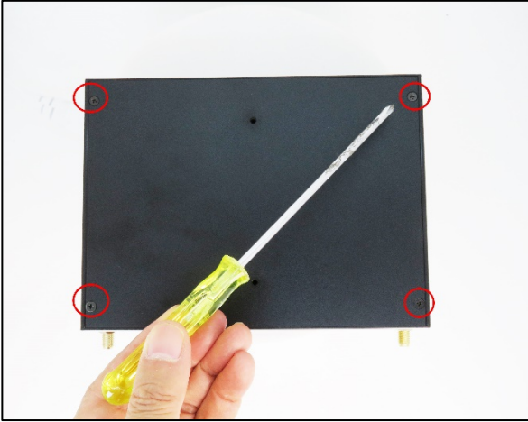
1. プラスドライバーでパソコン背面のネジ(4箇所)を取り外します。
