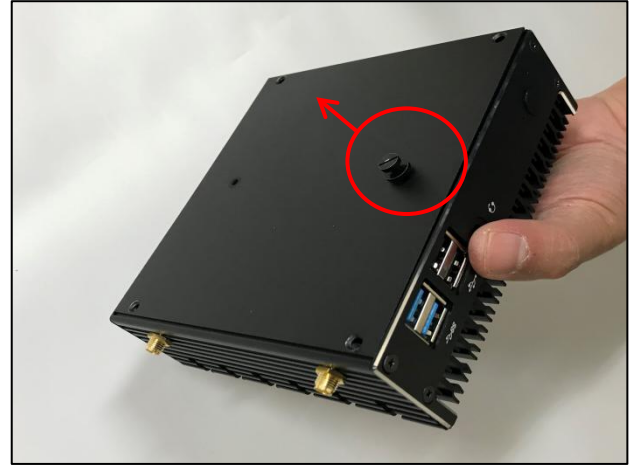
2. パソコン固定用ネジを1個取付け、それをツマミにして引き上げて底面を取り外します。
