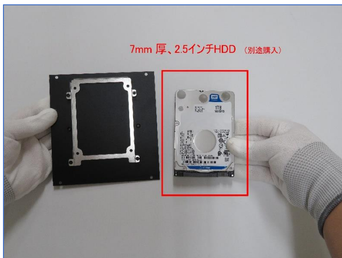
7. HDD 厚さ7mm 2.5 インチの取付け
