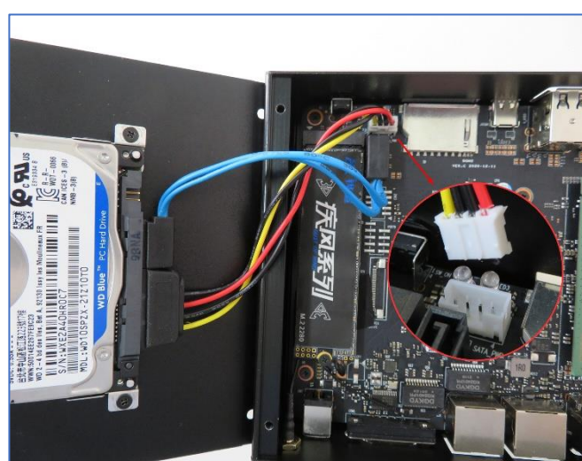
12. ハードディスクケーブルを 2.5 インチHDDの SATA インターフェースに挿入してください
