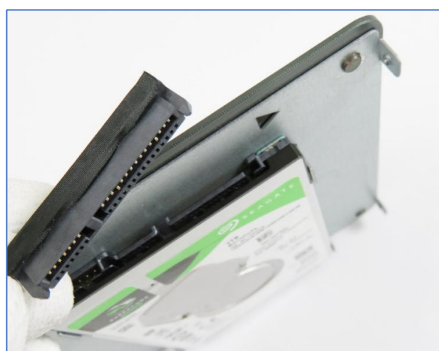
12. ハードディスクケーブルの一方の端を 2.5 インチHDDの SATA インターフェースに挿入してください。
