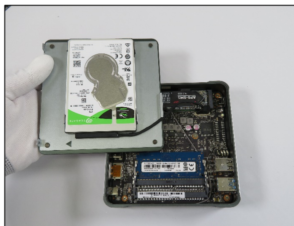
16 HDD の取付け完了です。
