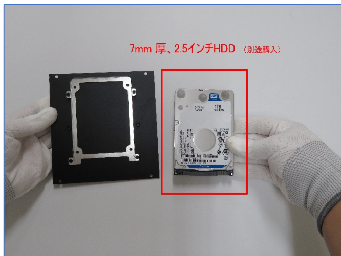
7. HDD 厚さ7mm 2.5 インチの取付け
