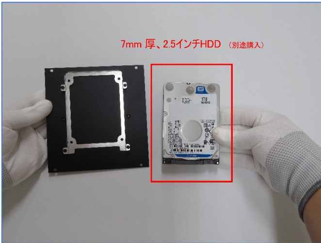
7. HDD 厚さ7mm 2.5 インチの取付け
