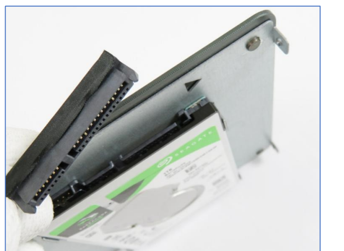
12. ハードディスクケーブルの一方の端を 2.5 インチHDD の SATA インターフェースに挿入してください。
