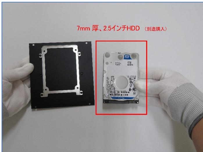
7. HDD 厚さ7mm 2.5 インチの取付け
