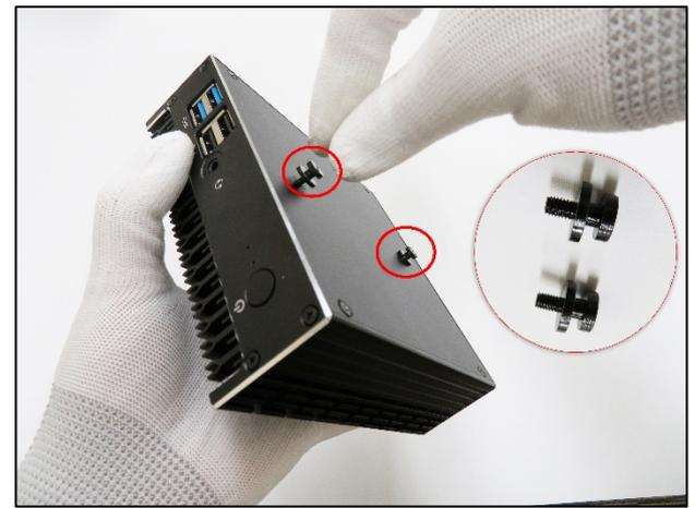
4. パソコン固定用ネジ(2個)を写真のとおり取付けます。
