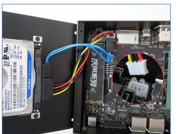
12. HDD を接続したケーブルを基盤側に挿し込んでください。
