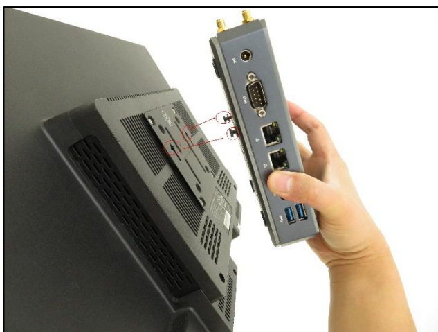
5. パソコンをブラケットのネジ穴に引掛けて取付けます。
