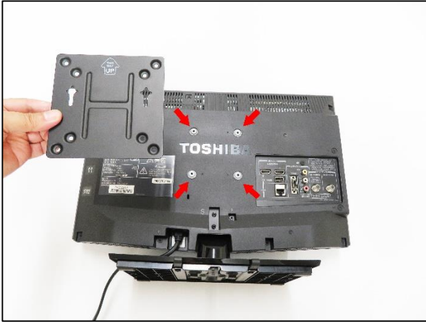
1. 付属品のブラケットをディスプレイの背面に取付けます。
