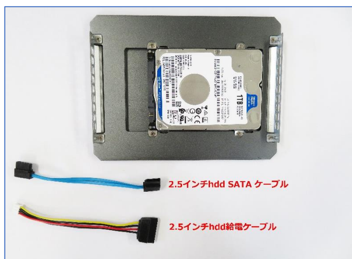
10. 付属の HDD 用の SATA ケーブルと給電ケーブルを使用します。
