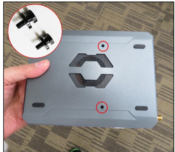
4. 付属品のパソコン固定用ネジ(2個)を取り出し、写真の様に取付けます。
