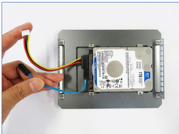
11. ケーブルで HDD と基板を接続します。
