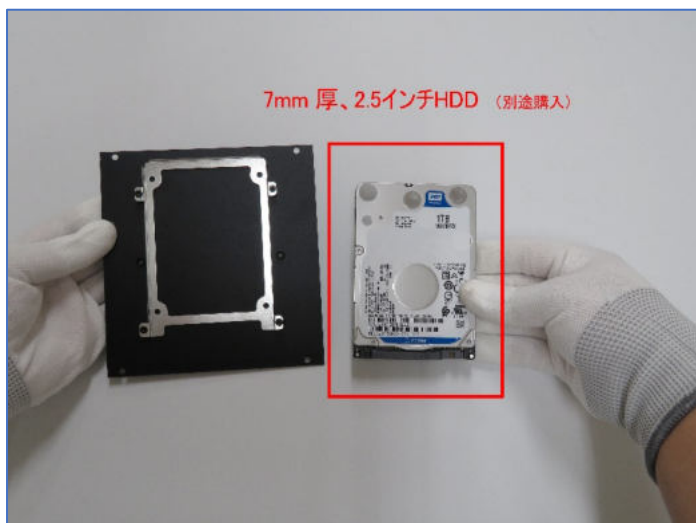
7. HDD 厚さ7mm 2.5 インチの取付け
