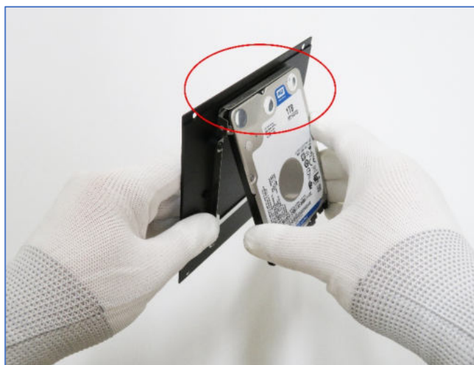
8. HDD とブラケットの装着位置を合わせます。
