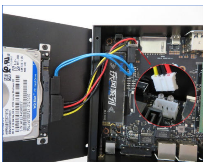
12. ハードディスクケーブルを 2.5 インチHDDの SATA インターフェースに挿入してください
