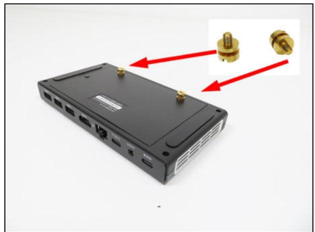
4. パソコン固定用ネジ 2 個を取り出し、パソコン本体の裏面に取付けます。
