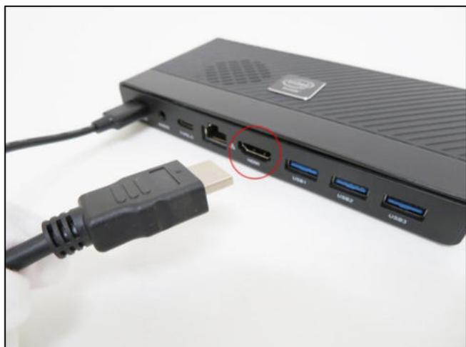
3. HDMI ケーブル(別途購入)でパソコンとディスプレイを接続します。4K 出力が必要な場合は、4K 対応の HDMI ケーブルをご用意ください。
