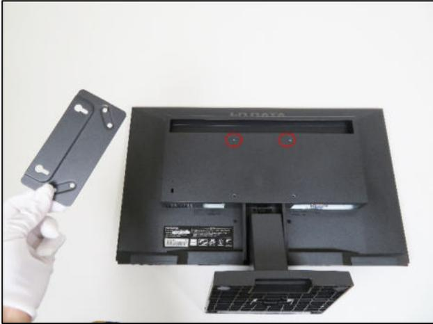
1. 付属品のブラケットを取り出し、ディスプレイの背面に取付けます。
