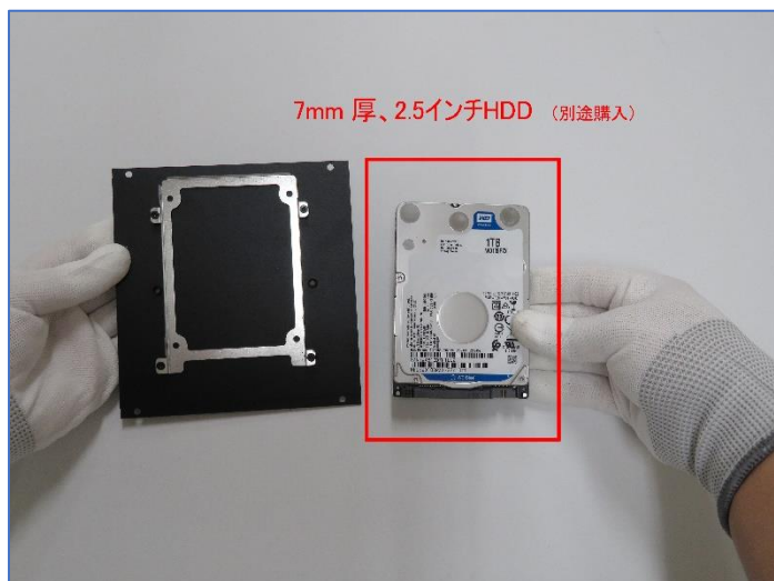
7. HDD 厚さ7mm 2.5 インチの取付け
