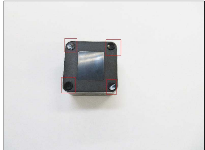
4. SSD ハードディスクの横にあるネジを外します。
