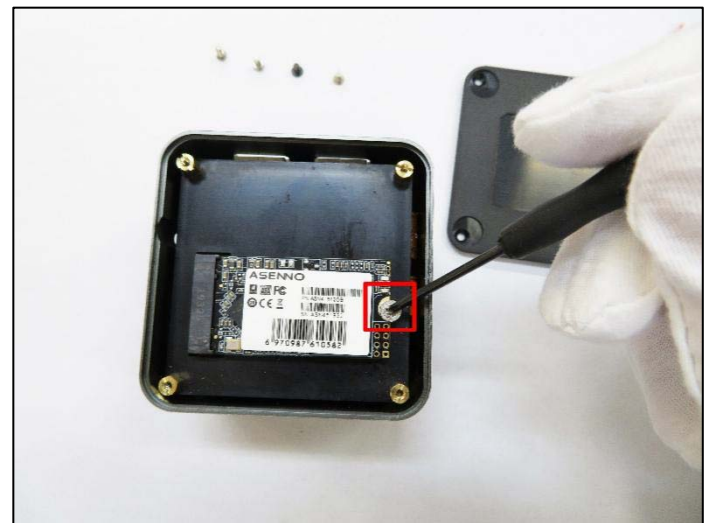
4. SSD ハードディスクの横にあるネジを外します。
